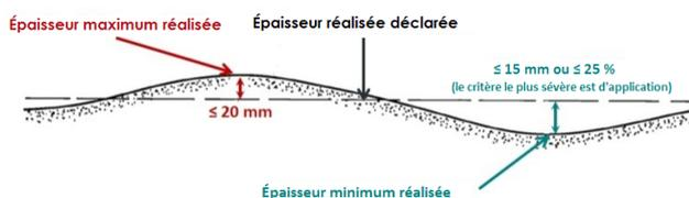
Fig. 1 – Détermination de l'épaisseur réalisée déclarée
